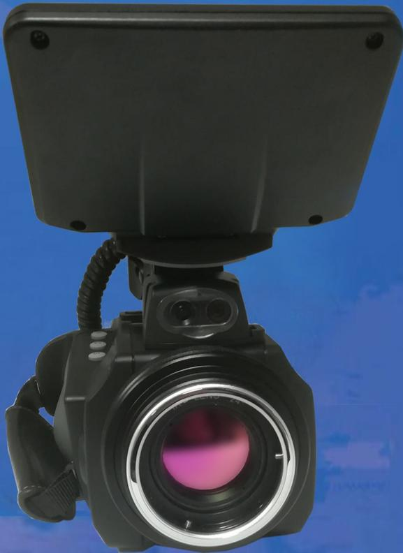
Varias opciones de lentes con diferente campo de visión están disponibles para la G96. El usuario puede escoger los lentes en concordancia a la aplicación y las condiciones del medioambiente, tal como: distancia, ángulo de visión teleobjetivo o macro, tamaño del objeto a inspeccionar, temperaturas a ser inspeccionada.
