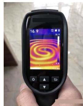
Verificar suelo radiante
