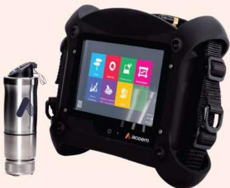
Se destaca por su sensor inalámbrico de tres ejes que toma mediciones simultáneas de vibración, gran pantalla táctil a color, detección automática de puntos de medición mediante códigos QR, accesorios integrados que incluyen pirómetro para medir la temperatura de los rodamientos, luz estroboscópica para medir la velocidad de rotación, cámara digital para una fácil identificación de la máquina e ilustración de informes, diseño resistente a golpes y mucho más.
