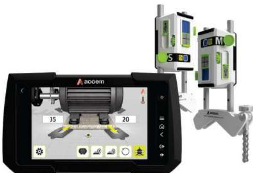
Su método Dual Sweep captura mediciones precisas durante la rotación del eje, lo que garantiza una alineación óptima. Apóyese del Dual Multipoint para diversos escenarios, capturando múltiples puntos para cálculos precisos.
